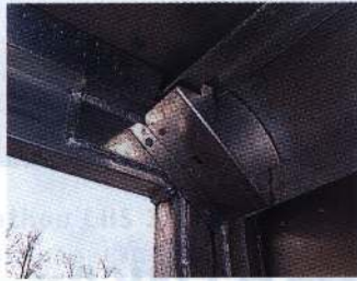
Усиливающие распорки в углах кузова прицепа стоят тут, похоже, для красоты и не обеспечивают конструкции достаточной жесткости. Итог – потрескавшийся металл в углах дверного проема
