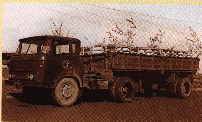
Серийная «Колхида» с семитонным полуприцепом ММЗ-584 – основной автопоезд на дорогах страны с 1964 по 1970 годы. Обратите внимание на забрызганный маслом диск заднего колеса – следствие подтекающего сальника. Фото автора
