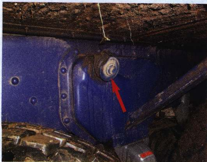
Через эти шкивы трос стоящей сзади лебедки протягивается вперед
