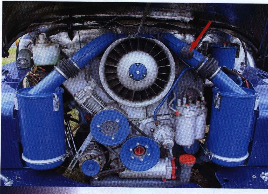
Двигатель T-928. Два больших синих бочонка – воздушные фильтры масляного типа. Стрелкой показан закрытый заглушкой канал в воздушном коллекторе, куда для подогрева при зимнем запуске можно подвести горячий воздух либо направить туда пламя обычной паяльной лампы
