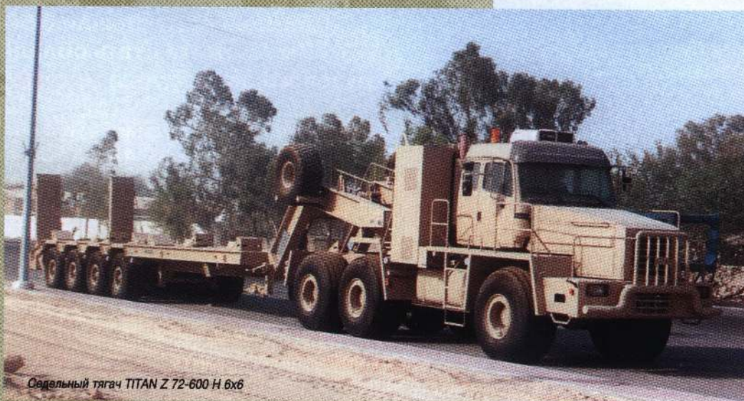
ТИТАН Z 72-600 Н 6х6 немецкого производства с полуприцепом Goldhofer ST 40-120/40 на трассе между Оманом и Эмиратами
