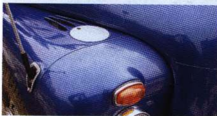
Воздухозаборники двигателя расположены в крыльях. Под пластиковой заглушкой – гнезда под установку шноркелей для преодоления глубоких бродов
