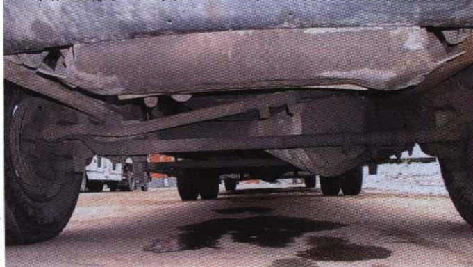
Передний ведущий мост фирмы Dana выдерживает нагрузку примерно в 2,35 т.
