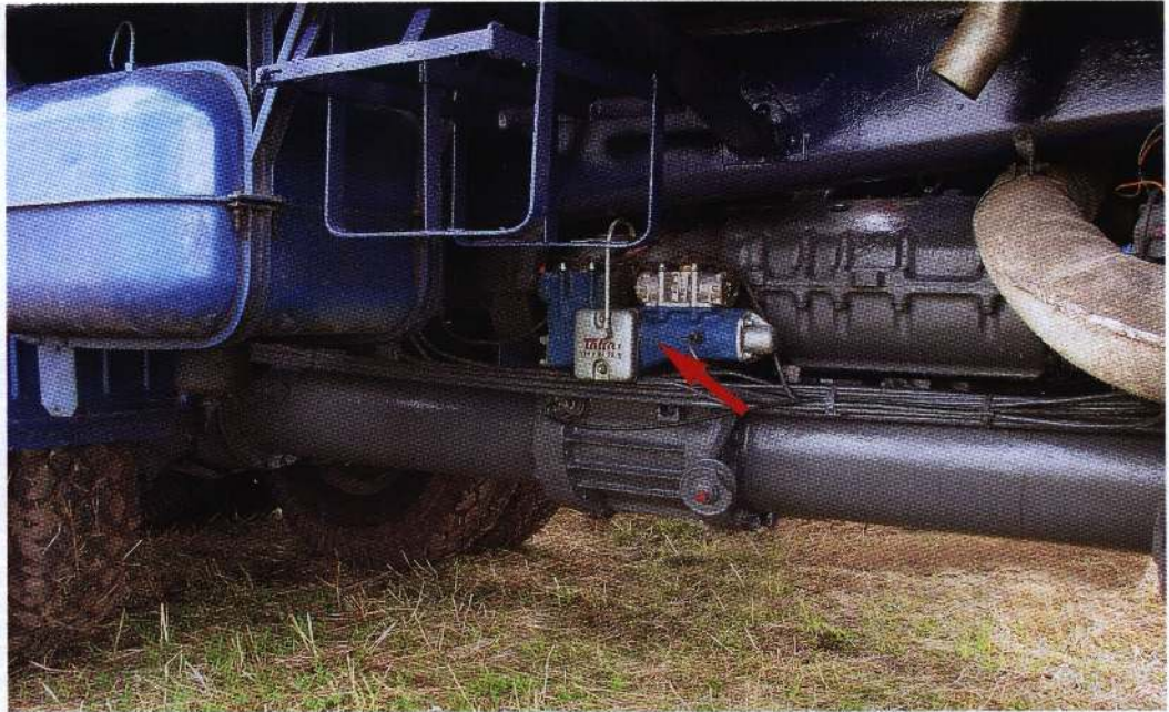
Электропневматический механизм управления дополнительной коробкой передач. Чуть ниже виден еще один блок, через который пропускается вперед трос лебедки
