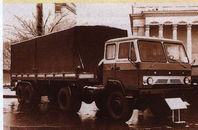
Опытный автопоезд повышенной проходимости КАЗ-4430 с полуприцепом КАЗ-9378 для транспортировки сельскохозяйственных грузов – экспонат выставки «50 лет Советского автомобилестроения» 1974 года. Фото автора
