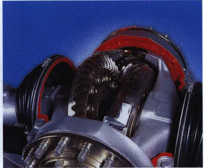
Картер главной передачи в разрезе
