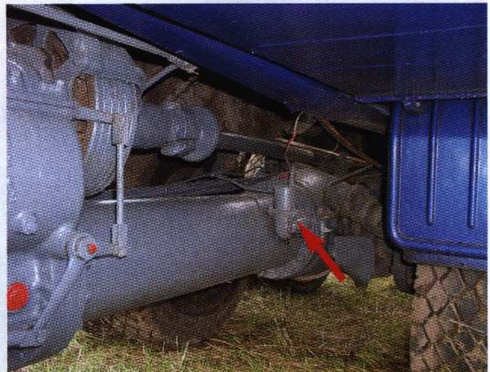
От дополнительной коробки передач идет приводной кардан на лебедку. Ручной тормоз действует на трансмиссию. Стрелкой показан электропневматический механизм блокировки межколесного дифференциала
